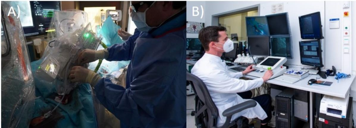
**Abbildung 2:** Installation des Roboterarms Corindus CorPath GRX (Siemens) im Herzkatheterlabor des Universitätsherzzentrums Freiburg-Bad Krozingen. A) Die Koronardrahte und Katheter werden manuell in den Roboterarm eingelegt. Anschließend kann sich das Personal von der Strahlenquelle entfernen. B) Die Steuerung der Intervention erfolgt raumlich getrennt ber eine Konsole aus dem Schaltraum.
